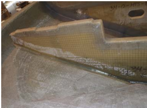
Photo 4 - シャット・ハーデング製FE1200のハルとストリンガーの接合、Crystic Crestomer 1152PA使用。
