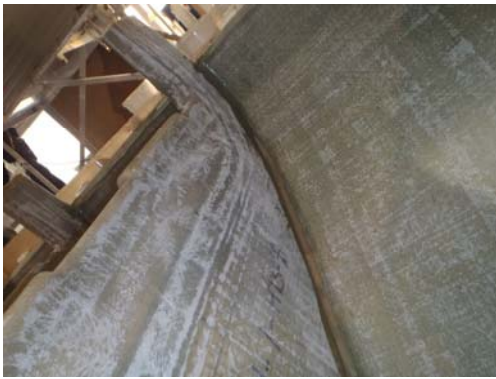
Photo 3 - シャット・ハーデング製FF1200のハル、バルクヘッドでCrystic Crestomer 1152PAで接合
